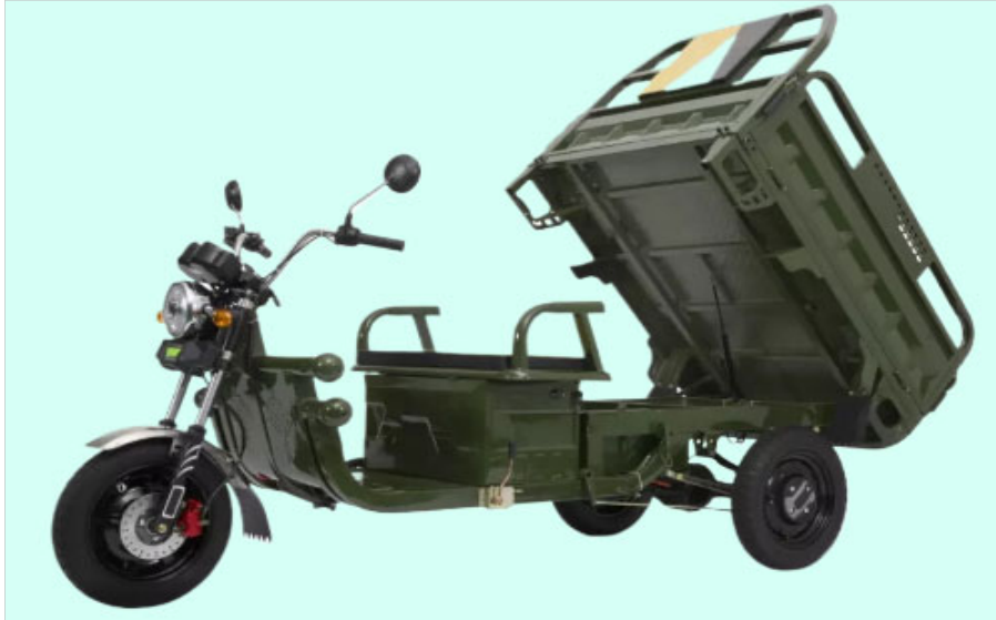
Photo.38 : Exemple de triporteur motorisé à benne, recommandé pour la collecte des déchets dans les ruelles étroites du 5 ème arrondissement, tel que Ridina – Cliché, Djabaye, 2023.
