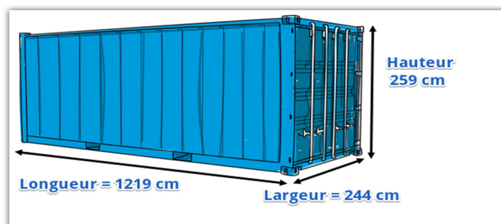
Fig.20 - Dimensions du conteneur du transport maritime de 40 pieds avant sa transformation
