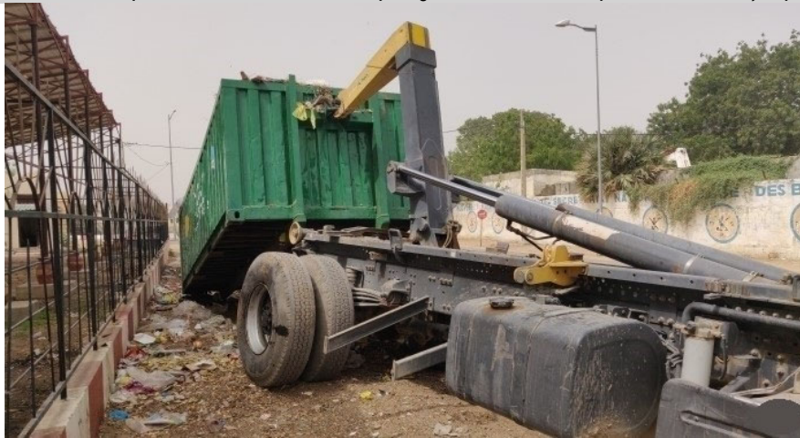
Photo.15 : Benne Ampliroll dans une manœuvre de portage d'un conteneur 40 pieds – Clichet : Djabaye, 2023
