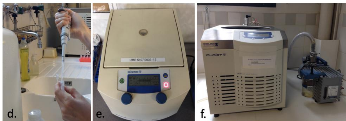
Figure A4. 2 : Illustration de quelques étapes du prétraitement, dont le remplissage d'acide acétique dans le microtube de poudre (d.), le mélange (e.) et la lyophilisation (f.)
