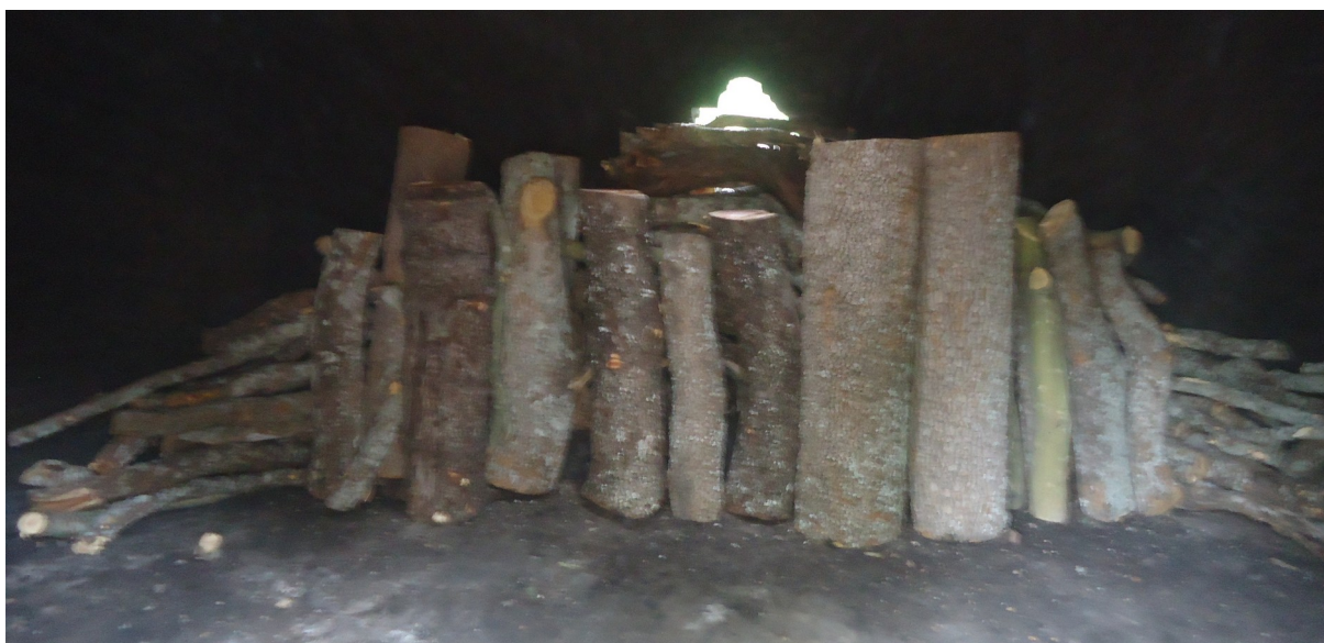
Illustration 31: L’intérieur d’un four à charbon en train d’être chargé. Le 18 mars 2022.
