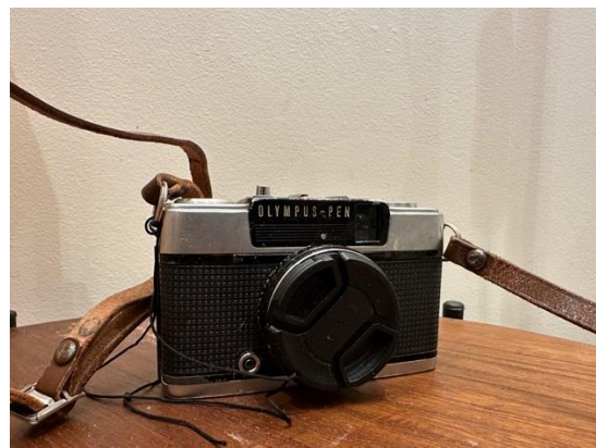
Olympus pen EE3 : plage d'iso de 25 à 400. Objectif 28 mm non interchangeable, demi-format.
