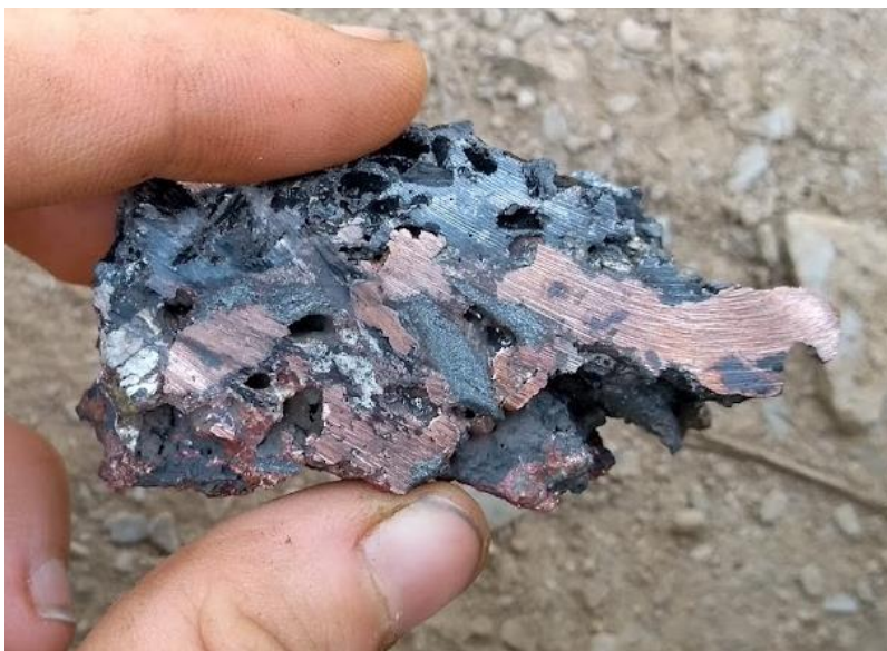
Figure 35 : Scorie expérimentale obtenue après la fonte d'un mélange de bindhémities oxydées et de barytes. Le cuivre (orangé) est présent dans la scorie (gris sombre). Photographie : Céline Tomczyk.
