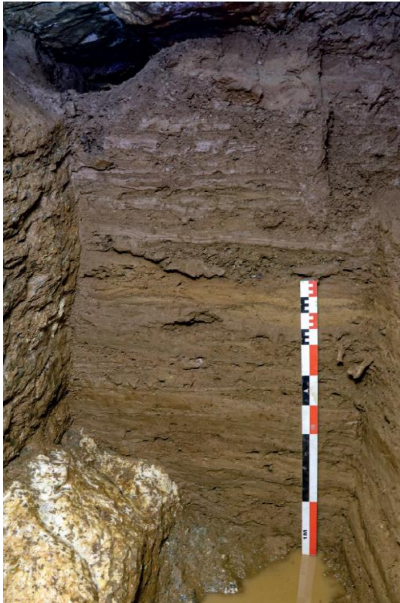
Figure 13 : Remplissage sédimentaire (alternance de sédiments sableux et d'argiles compactes) surplombant un filon à gangue de baryte (minéral blanc) dans la galerie principale de la mine de la Salière (Viala du Tarn, Aveyron). Photographie : Nicolas Minvielle.
