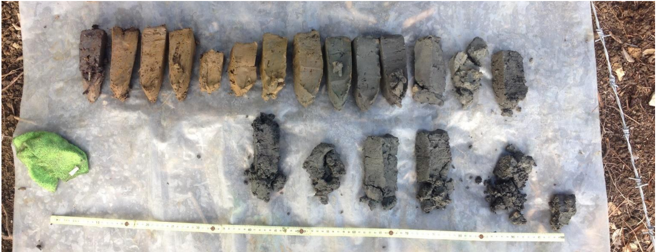
Sédiments extraits par tranches de 20 cm avec une tarière manuelle. Photo : S. Chapkanski
