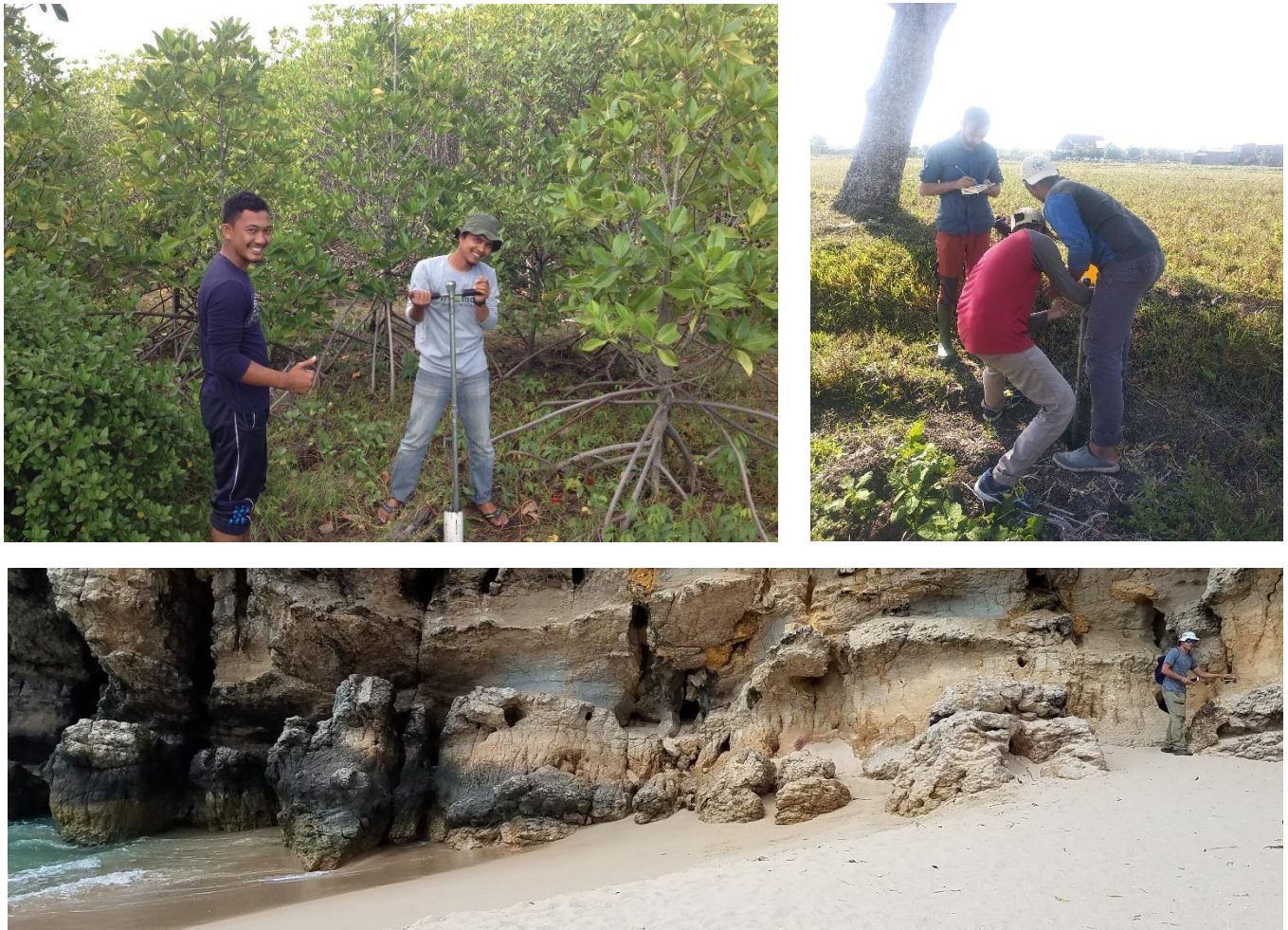
Figure IV. 7 : Collecte d'échantillons de sédiments par une tarière manuelle (à gauche et à droite). Collecte de marqueurs du niveau marin holocène le long des falaises (en bas).
